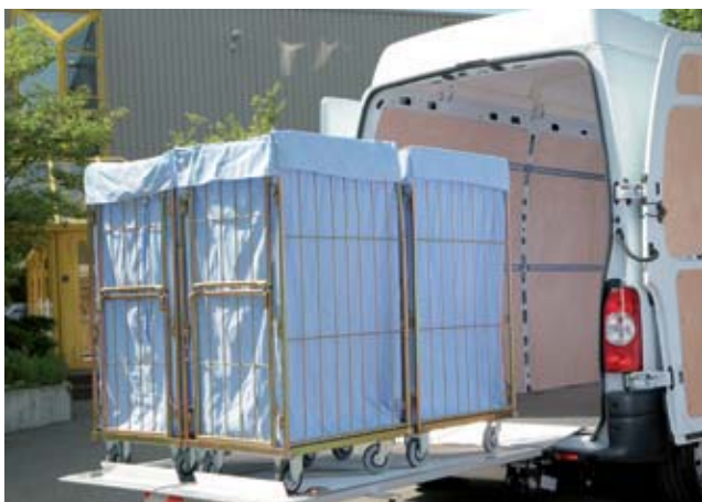
Быстро и безопасно: большая платформа с рольстопами для 4 тележек для прачечной или 1 тележки с продуктами питания.
