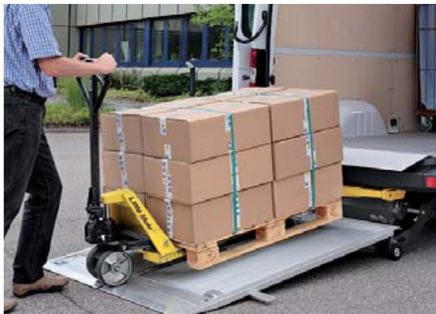
Достаточно места как для для европаллеты так и для роклы. Очень низкий угол подъёма (6,2°). Принимать во внимание вес паллеты. Безопасность работы на платформе с TragGrip и SideGrip.
