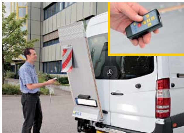
Открытие с помощью гидравлики как и на „больших“ моделях Cargolift.
