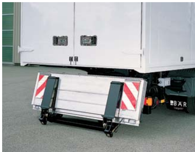
Механическая установка платформы при спуске
